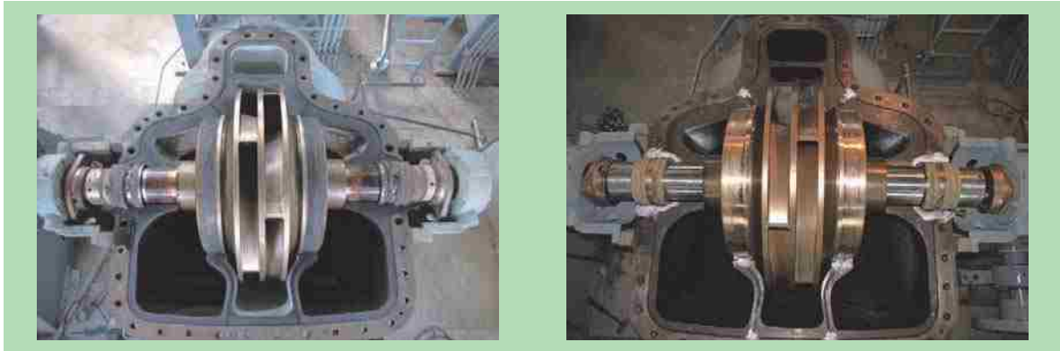
主ポンプの分解補修 (羽根車等の整備補修)
